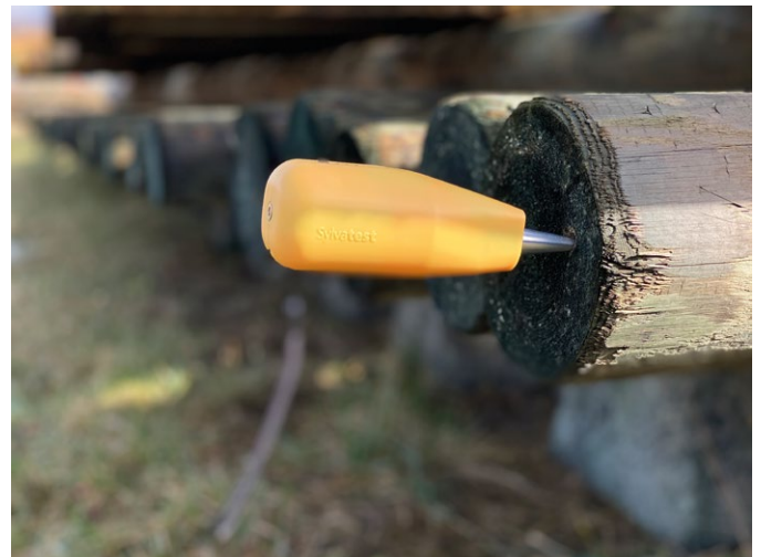
Le SYLVATEST classe les poteaux en fonction de leur qualité et confère un label LUXPOLE (S - L ou XL) - cbs-cbt.com/fr/
